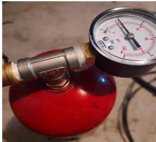
GRAFICO 18. Prueba de fuga en el Almacén.
